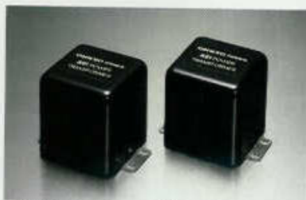
AEI-Netztransformatoren mit Siliziumstahl-Abschirmung reduzieren den magnetischen Streufluß im Vergleich zu herkömmlichen EI-Spannungswandlern auf 1/10 bis 1/20.
